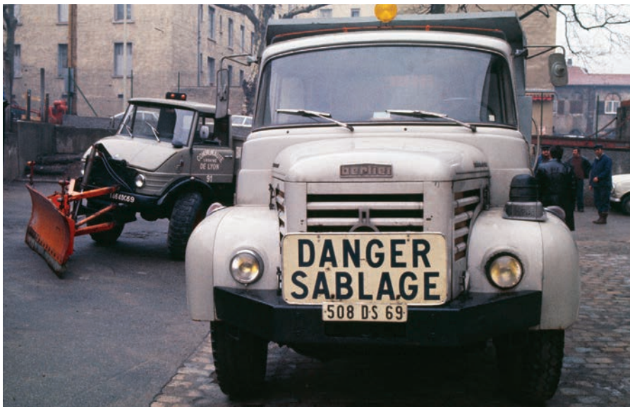
5194W007-1 - Avant d'un camion plateau équipé d'une épandeuse pour servir de saleuse (1985).
