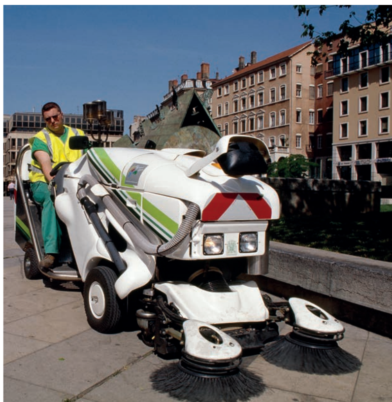
4542W005 - Essai de nettoyage avec la micro-balayeuse de trottoir (2002).
