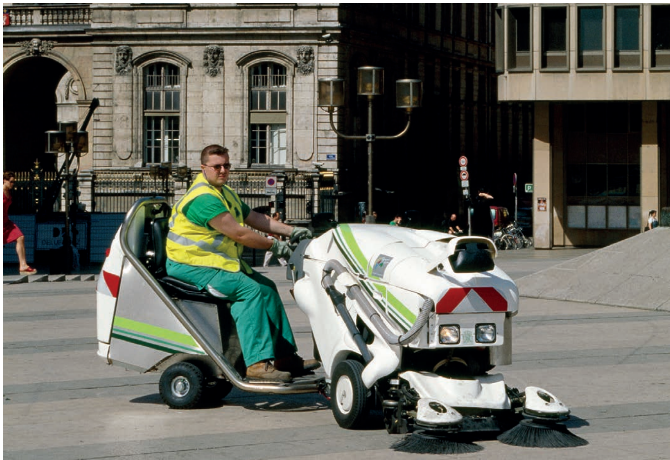
4542W007 - Essai de nettoyage avec la micro-balayeuse de trottoir (2002).
