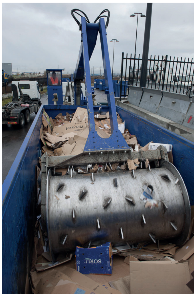
4875W015 - Compactage des cartons avec le compacteur à rouleau (2013). © Communauté urbaine de Lyon - Auteur inconnu.
