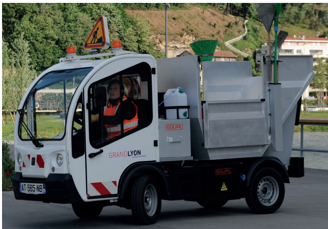
4619W017 - Agent conduisant un Goupil, véhicule équipé d'une micro-benne et d'un jet à haute pression (2011).
