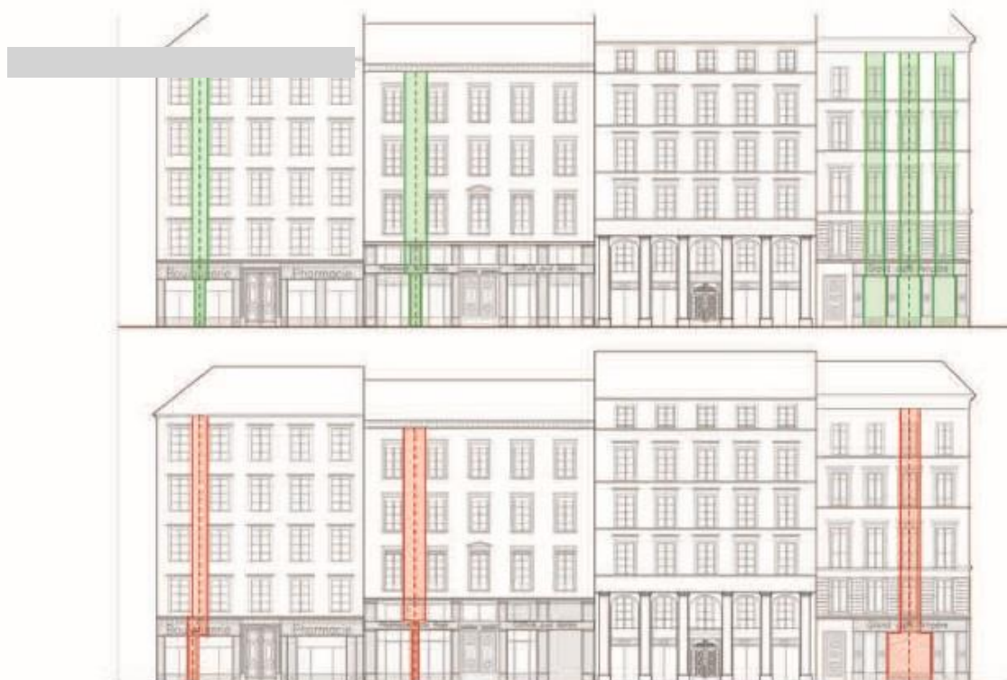
La position et dimension des piliers de la devanture découle de la composition de l'immeuble. La devanture est modérément plus ouverte que celui-ci.
