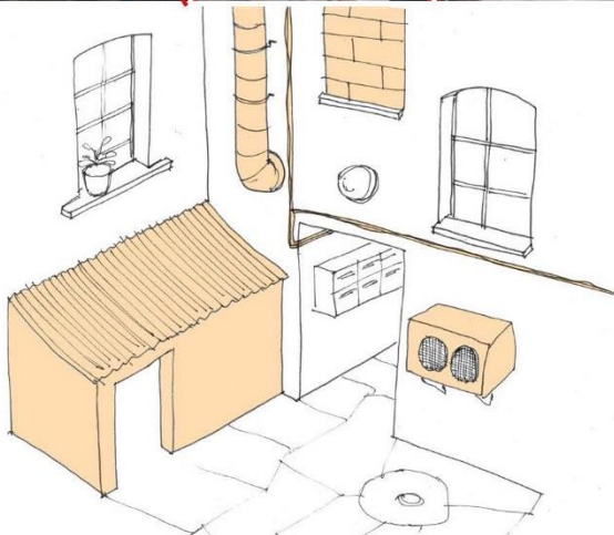
Quelques éléments devant être ciblés lors de travaux : gaines d'aération, installations électriques, appareils de climatisation... ces éléments doivent être intégrés. Les appentis «parasites» pourraient être démolis pour valoriser la cour.
