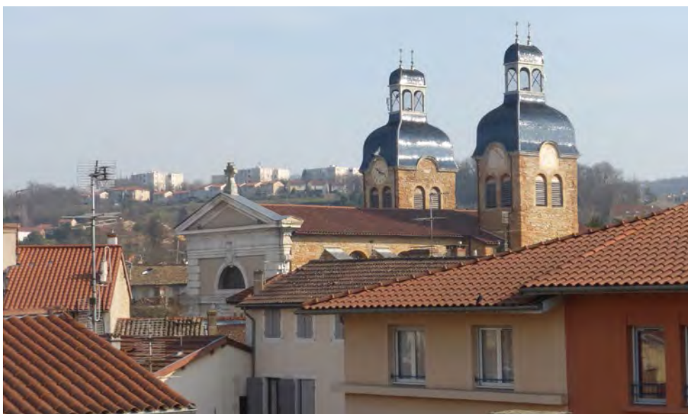
L'usage de la terre cuite est pour l'essentiel cantonné aux couvertures en tuiles, rondes ou mécaniques. Les demeures les plus nobles utiliseront des ardoises.
