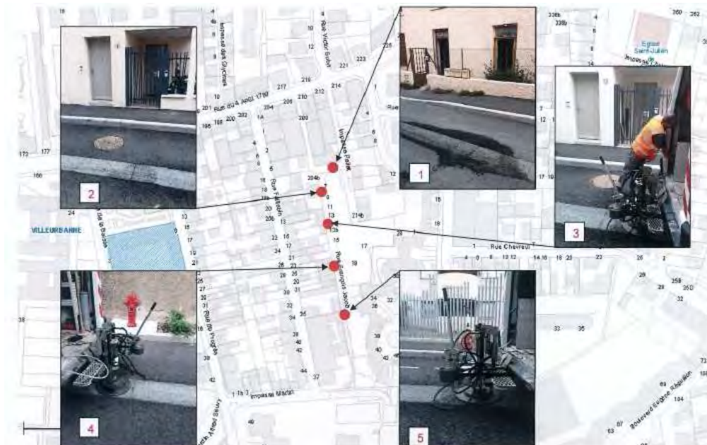
Figure 11 : Points de mesure au drainomètre sur la rue François Jacob (Crédit image : Grand Lyon)
