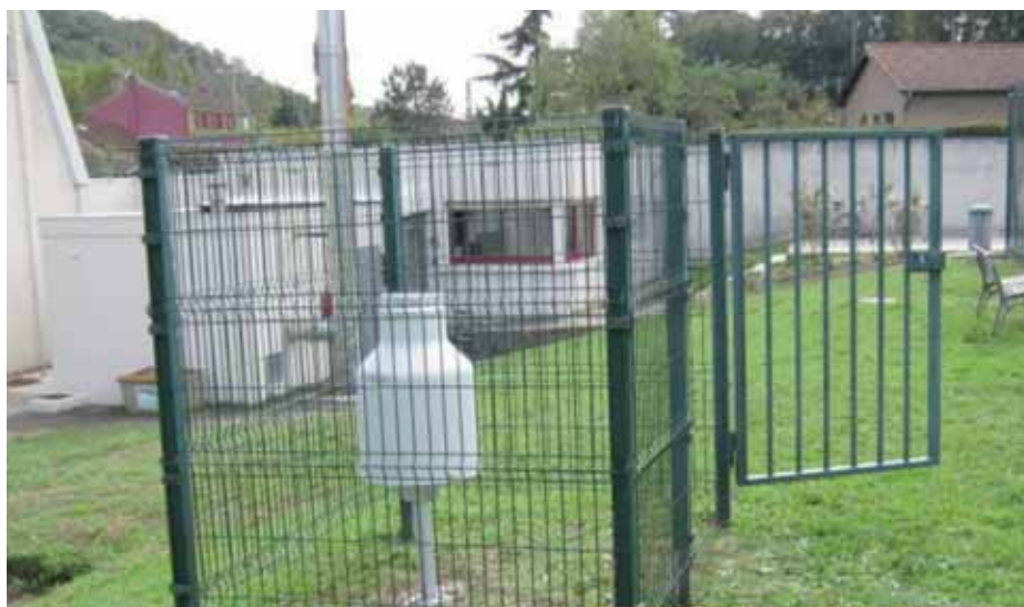
> Pluviomètre à pesée à Collonges-au-Mont-d'Or
