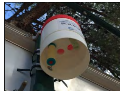
Échantillonneur passif Passam dans son abri
