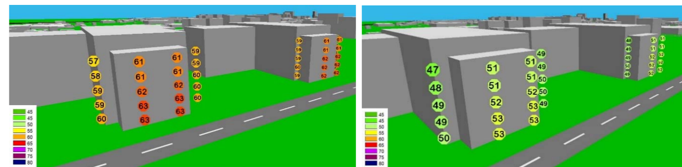
Contribution sonore de la voie LAeq 6h-22h (gauche) et LAeq 22h-6h (droite) en façade sud de l'Arche de Teodora 59-69 rue de Verdun
