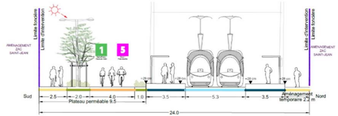
Figure 138: Organisation de l'espace au niveau de la station Saint-Jean Centre (Proposition, AVP de T9, 2022)
