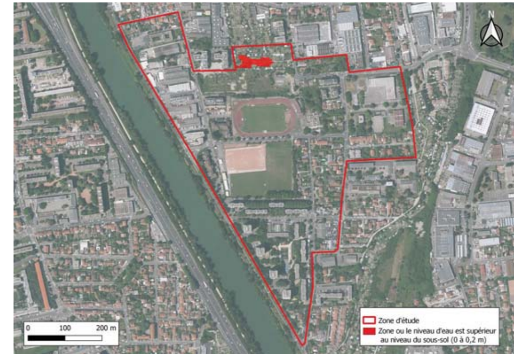
Figure 32 : Hauteur d'eau potentielle dans le sous-sol en cas de niveaux piézométriques de hautes eaux saisonnières
