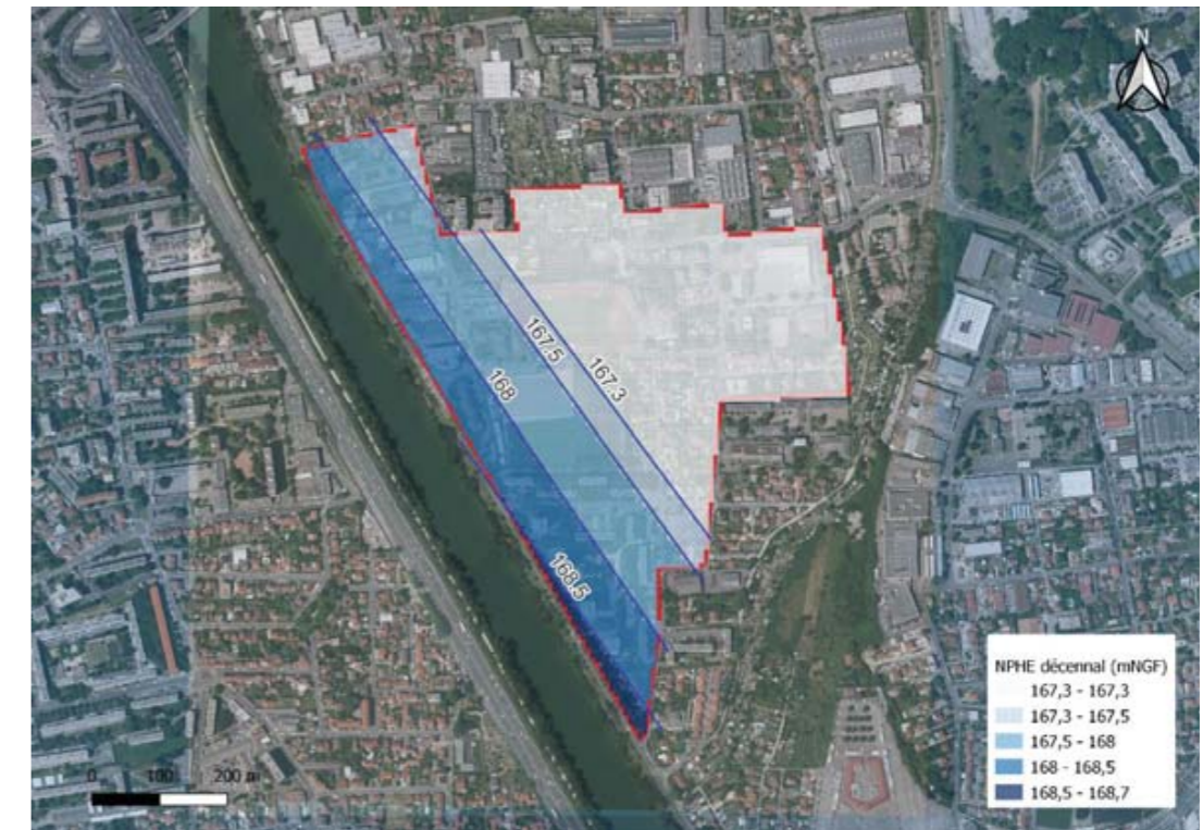
Figure 8 : Carte piézométrique du NPHE décennal de la nappe des alluvions de l'île de Miribel-Jonage
