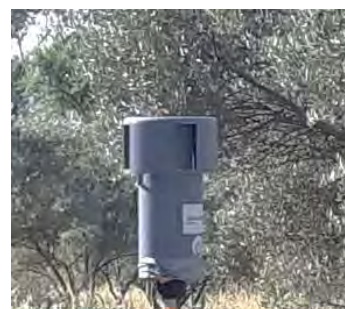
Figure 44 : Principe de l'échantillonneur passif Passam
