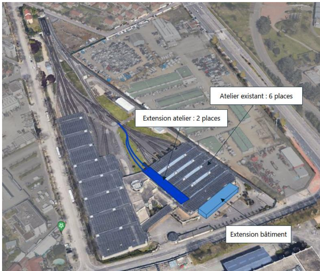
Figure 10 Projet d'extension de l'atelier
