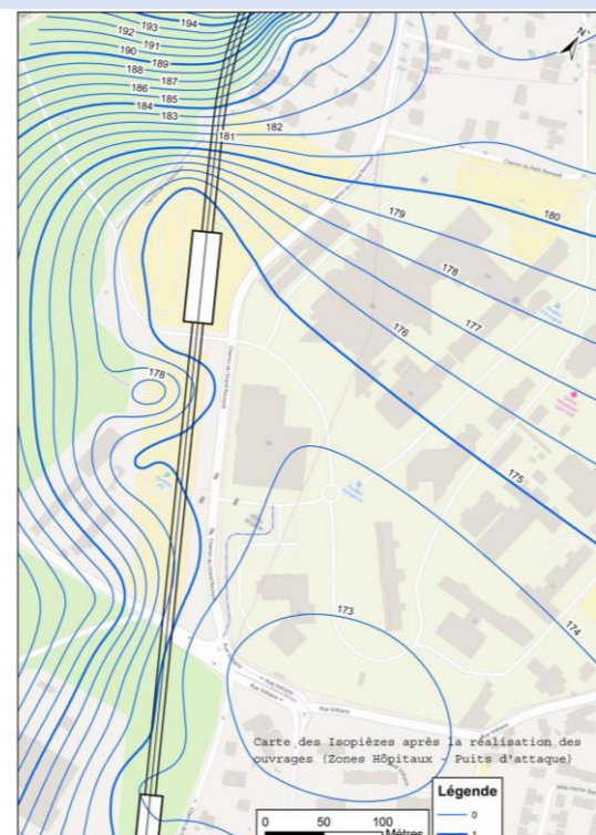
Carte des isopièzes après la réalisation des ouvrages des Hôpitaux au puits d'attaque (Source : AVP - Evaluation du risque d'effet de Barrage)
