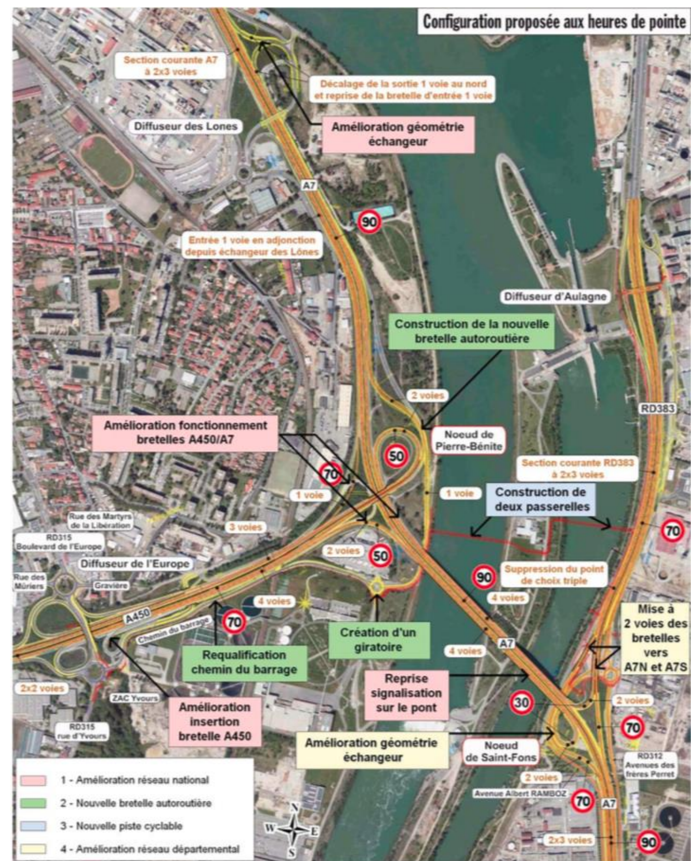
Aménagements des échangeurs d'extrémités de l'A450 et de l'A7 (source : dossier d'enquête publique préalable à la DUP)
