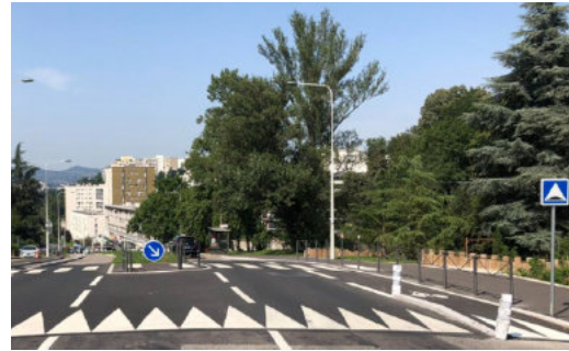
Illustration du plateau à créer, en recherchant une rampe plus longue avec moins de pente Source : Ville à Vélo
