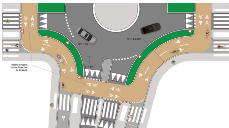
Préconisation de traitement d'un giratoire compact dans le cas d'une piste bidirectionnelle
