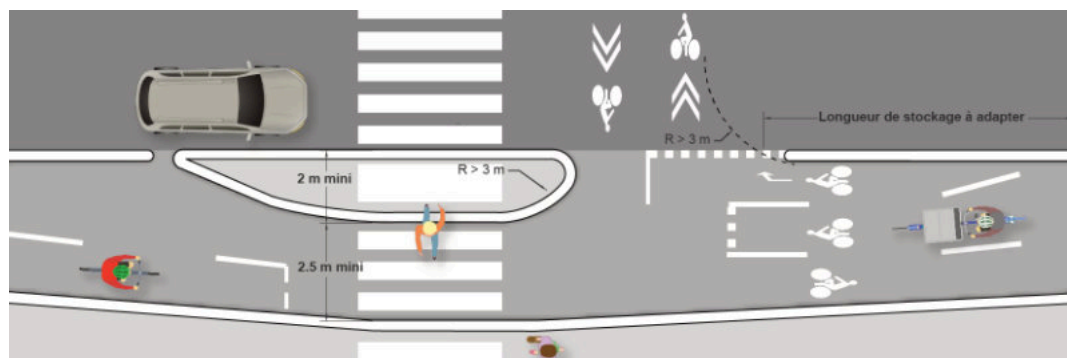
Jonction avec une liaison cyclable secondaire dans le cas d'une piste unidirectionnelle
