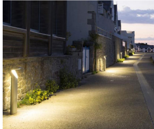
Les éclairages bas ne sont pas recommandés : trop rasants, ils ne permettent pas une visibilité claire de la piste sur toute sa largeur.
