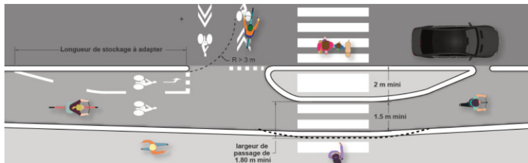
Jonction avec une liaison cyclable secondaire dans le cas d'une piste unidirectionnelle
